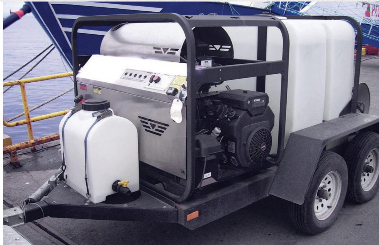
Hidrolavadora autónoma, para lavado con alta presión, caliente y frío con estanque de 260 galones, 3500 psi de presión, funciona con agua dulce .
