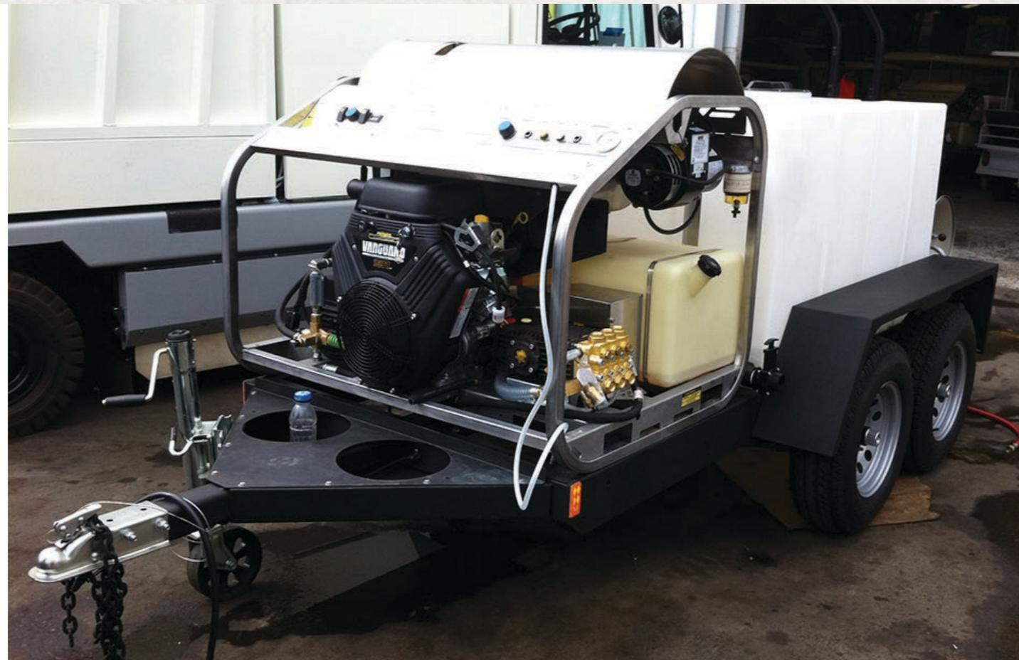
Hidrolavadora autónoma, para lavado con alta presión, caliente y frío con estanque de 340 galones, 3500 psi de presión, funciona con agua dulce.
