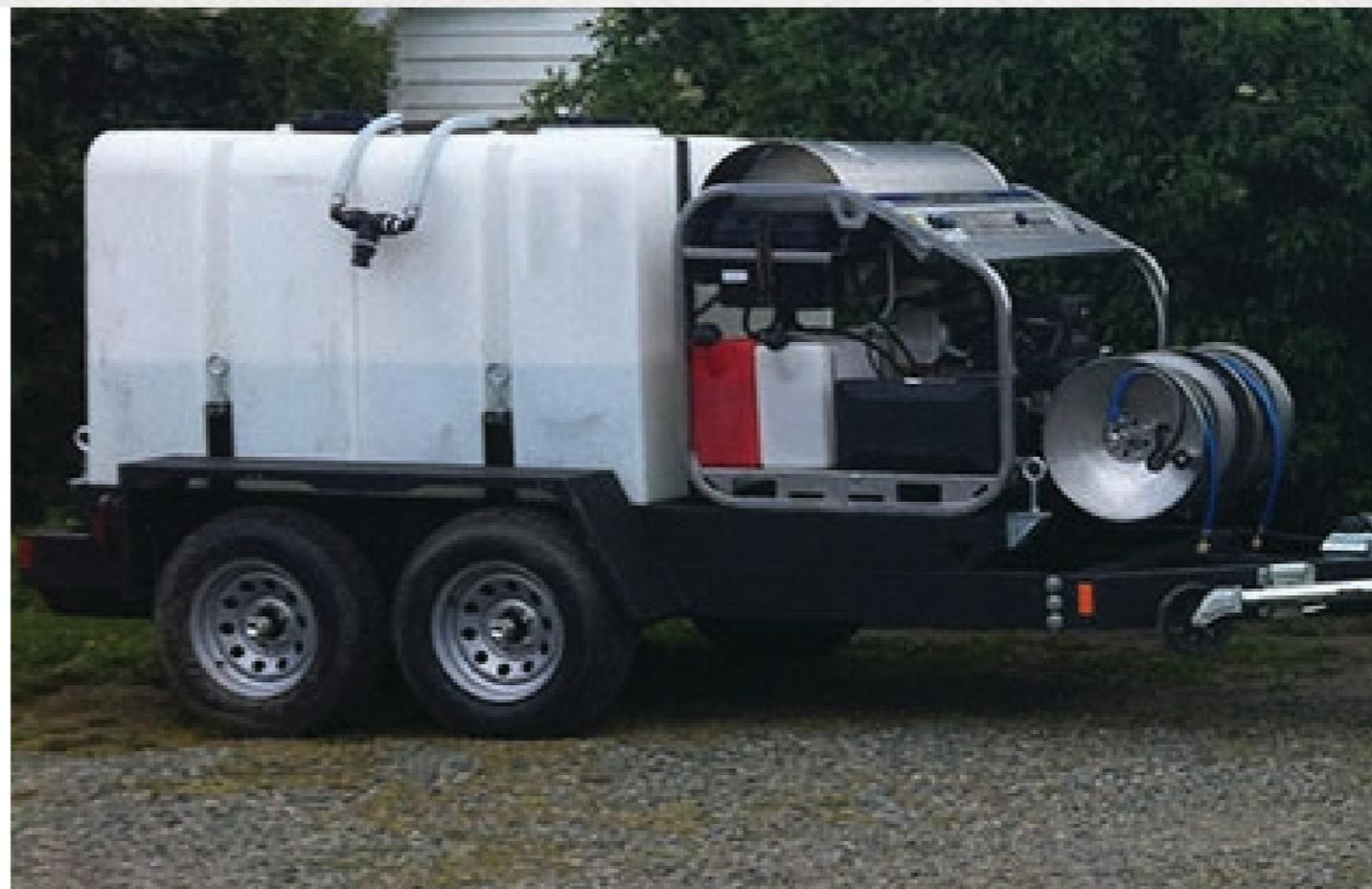
Hidrolavadora autónoma, para lavado con alta presión, caliente y frío con estanque de 500 galones, 3500 psi de presión, funciona con agua dulce y salada.
